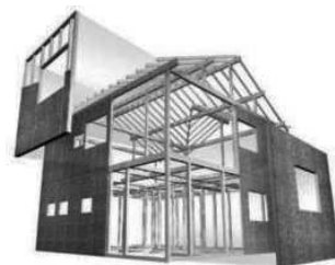
プレカットとパネル工法の組み合わせで、均一な仕上がりを 実現し、上棟から中間検査までの日程を大幅に短縮します
